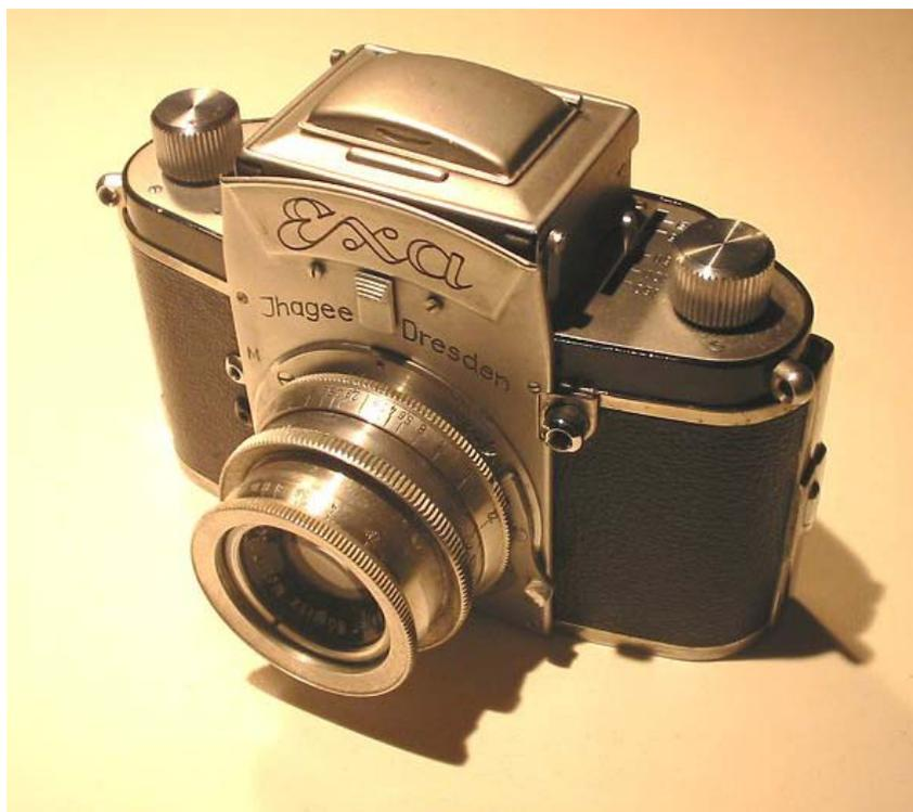
Exa versione 1 #224525 compresa nel range identificato da A&R (200000 - 235000). Questa versione ha due prese bipolari M (per tutti i tempi) X (per il flash elettronico) per 2 diverse sincronizzazioni. La finitura rigata è sostituita da una finta pelle a grana sottile. La macchina è in buone condizioni. Borsa di cuoio.
