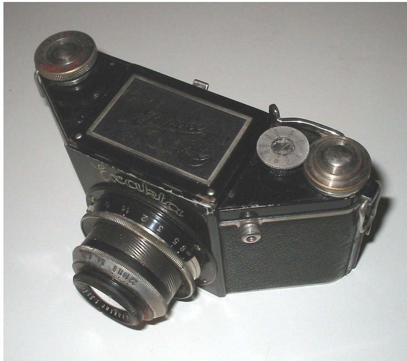
Il blocco dell'infinito è sulla destra e per giunta c'è la presa bipolare vacublitz (come nella versione 4). Nella versione 2 l'avanzamento della pellicola avviene col pomello da 22mm, mentre in questo caso c'è la leva di carica, così ho attribuito a questa macchina la versione 2-3-4 (un cocktail). Esteticamente buona, tendine pessime.
