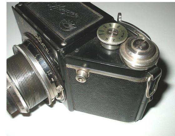
T.M and Reg. sul frontale. La differenza con la versione 4 è visibile, si tratta del terzo foro filettato per fissare il flash. Funziona bene anche se le tendine sono trasparenti. Esteticamente in condizioni molto belle.
