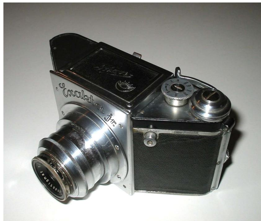
La presa bipolare per il flash è stata sostituita in questa macchina con due prese synchro; una è stata marcata X (electronic), l'altra è probabilmente per i bulbs. Funziona ed è bella esteticamente.
